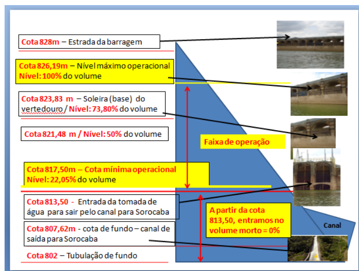
Figura 3 - Croqui da barragem de Itupararanga e da operação do reservatório
